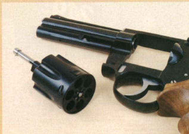
Schlossteile sind aus geschmiedetem, hochwertig vergütetem Stahl, der auf 130 bis 140 Kilogramm Zugfestigkeit vergütet ist. Der gesamte Revolver ist also gehärtet. Verschleiß tritt hier kaum auf - eine Waffe, die für die Ewigkeit gebaut scheint.
