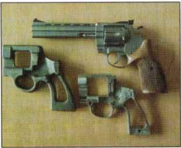
Drei Stadien eines Colts: der geschmiedete, unbearbeitete Rahmen, der gefrägte Rohling, die fertige Waffe.
